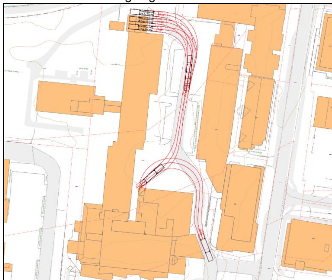
Figur 5: Spøringsanalyse utført av Norconsult 01.07.2025 viser manøvrering av buss som skal parkere på nordsida av Sunnfjord hotell.
